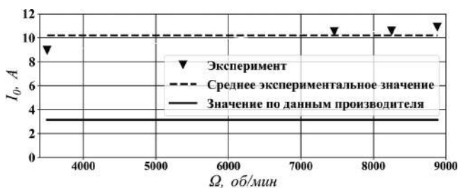
Рис. 4. Зависимости тока холостого хода двигателя Q100-6М от частоты вращения
