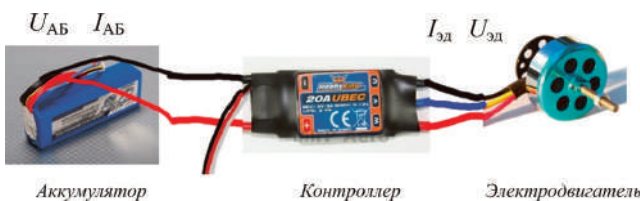
Рис. 2. Схема подключения бесколлекторного электродвигателя
