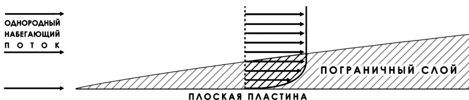
Рис. 4. Схема обтекания пластины однородным набегающим потоком
