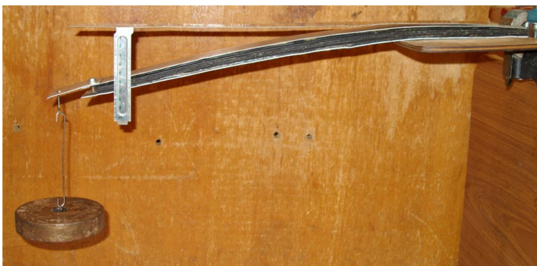
Рис.11 Вид упругой линии трехслойной балки, полученной в эксперименте а- свободное нагружение, б- стесненное нагружение.
