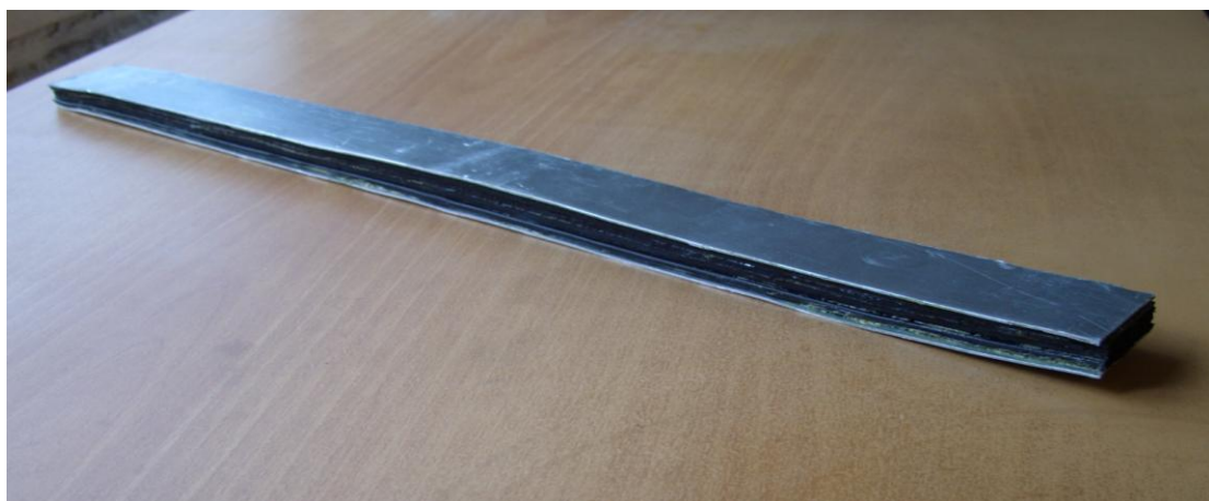
Рис.3 Общий вид и геометрические размеры образца трехслойной балки
