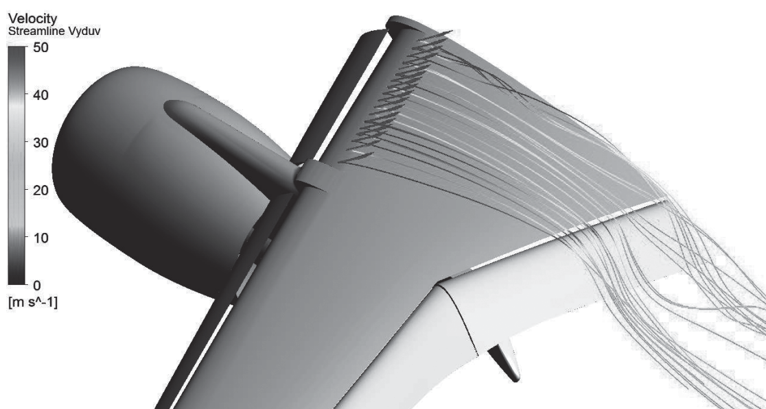
Рис. 8. Картина линий тока в корневой части крыла при выдуве струй на верхнюю поверхность
