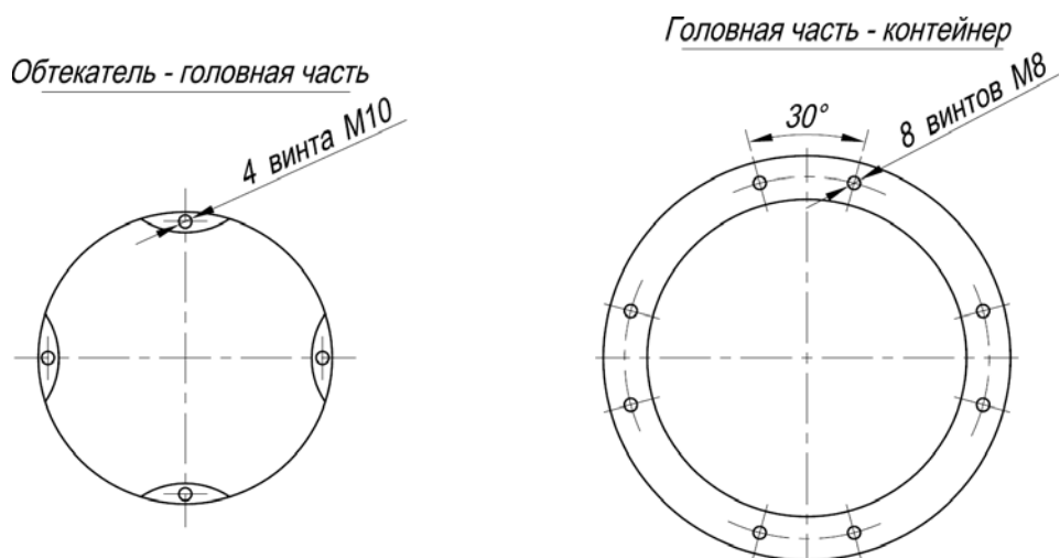
Рис. 1. Конструкции стыков обтекателя, головной части и контейнера
