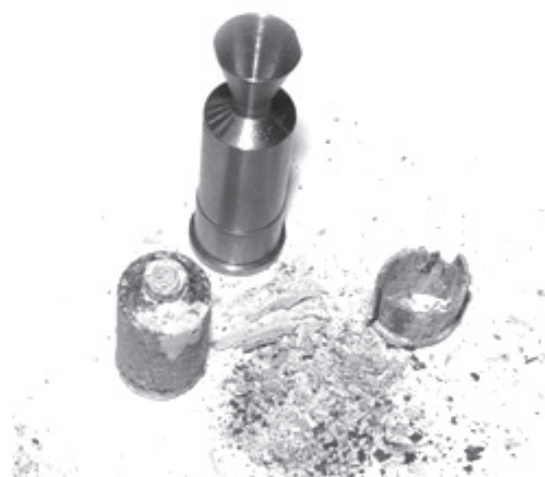
Рис. 1. Тантал-вольфрамовая КС в исходном состоянии и после отжига на воздухе
