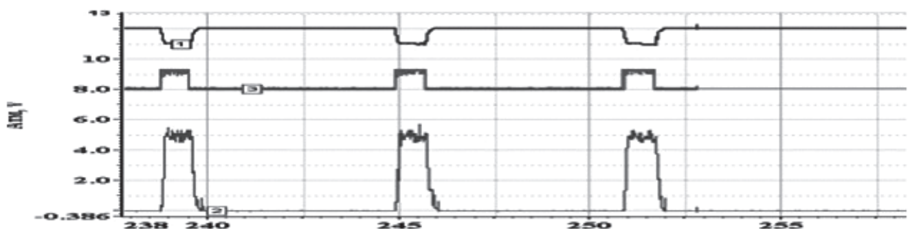
Рис. 7. Осциллограммы давления при включениях длительностью 1,2 с
