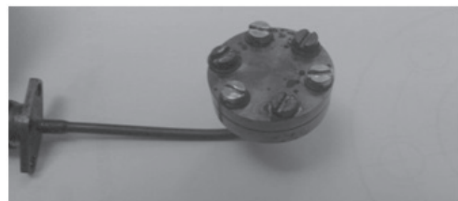
Рис. 3. Внешний вид прокладок «графлекс» для ТКД после испытаний на ЗТ
