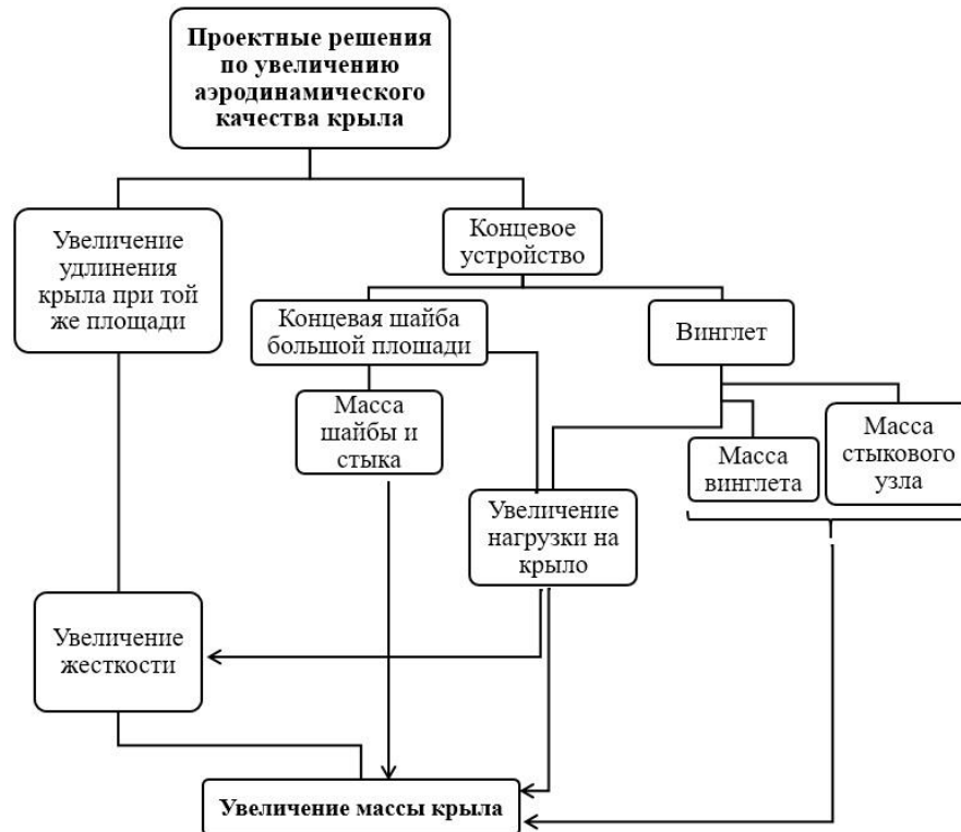
Рис.1- Блок-схема причинно-следственной связи между ростом аэродинамического качества разными проектными решениями, и итоговым ростом массы крыла.
