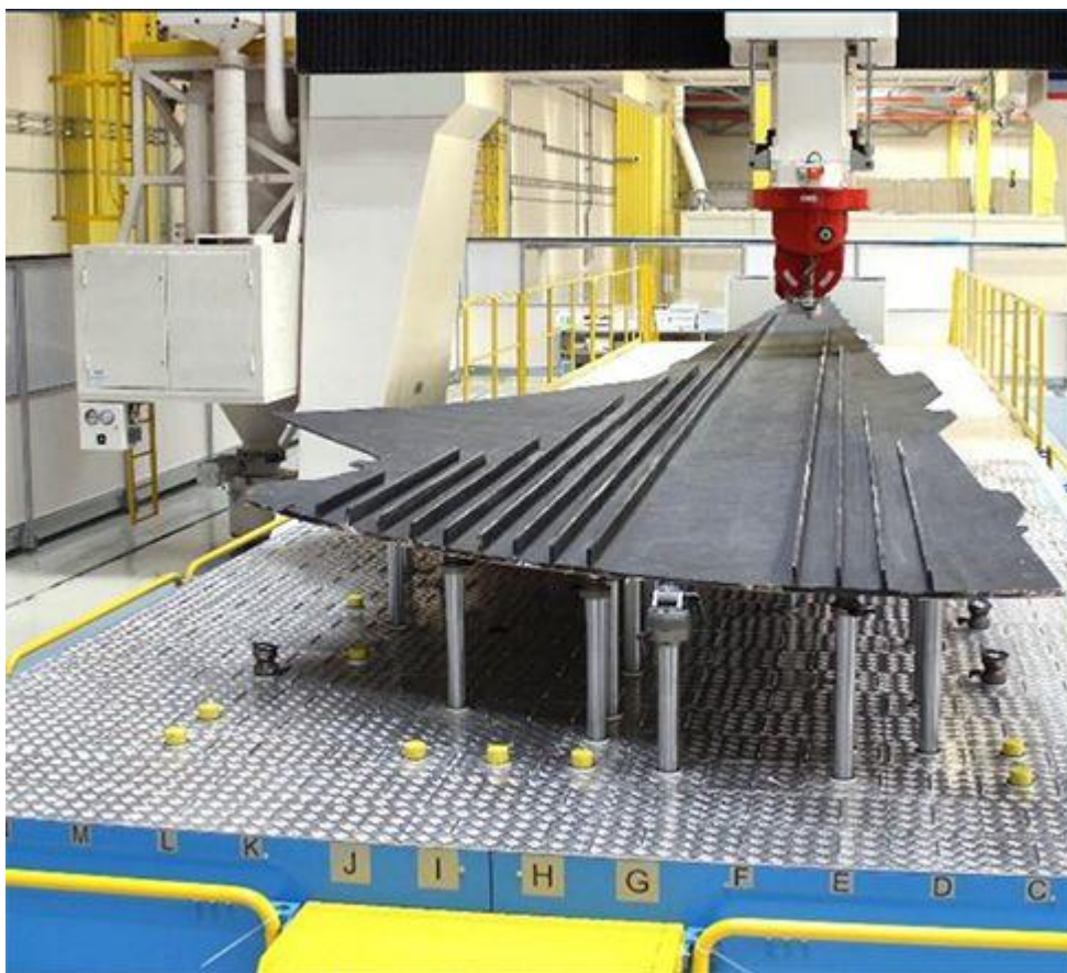
Рисунок 8 - Верхняя панель крыла со стрингерами из полимерных композиционных материалов (ПКМ)
