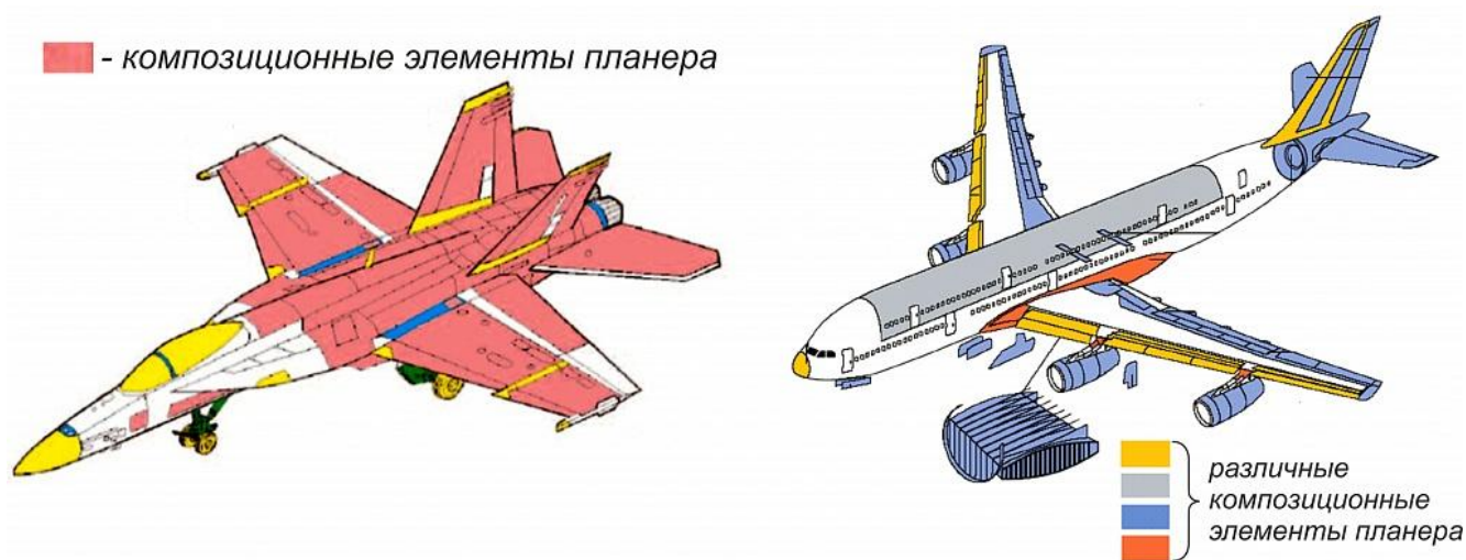
Рисунок 3 - Композиционные элементы в конструкциях планера боевой и гражданской авиации
