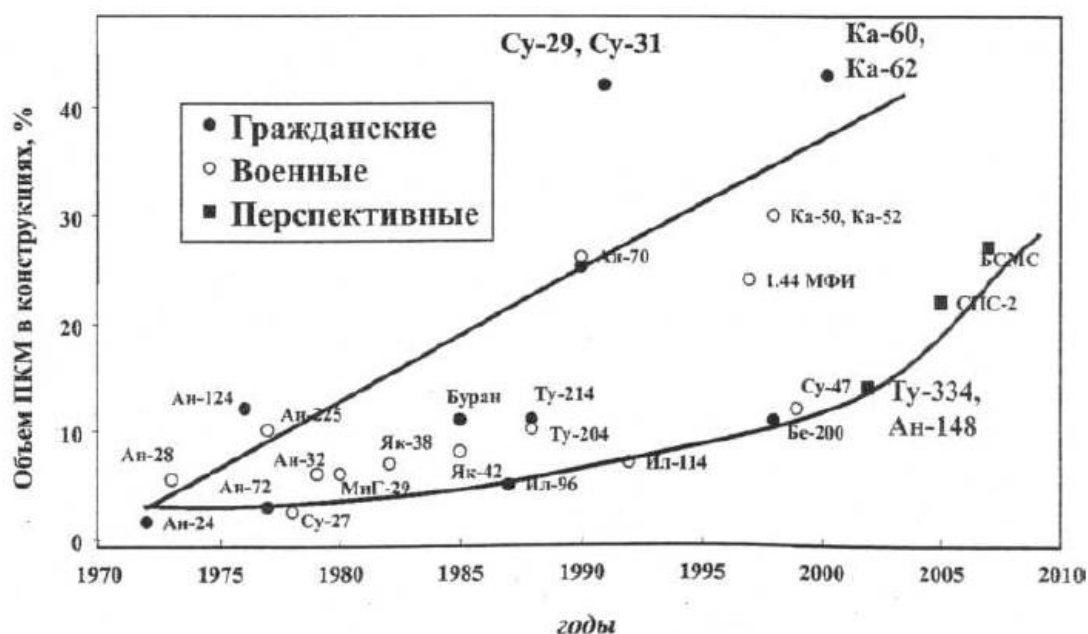
Рисунок 2 - Расширение объёмов применения полимерных композитов в конструкциях авиакосмической техники
