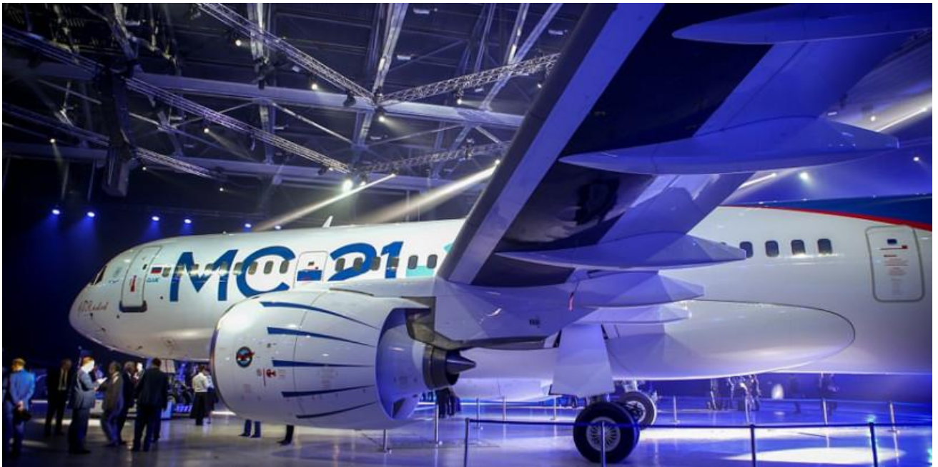
Рисунок 4 - МС-21 – инновационный самолёт с композитным крылом
