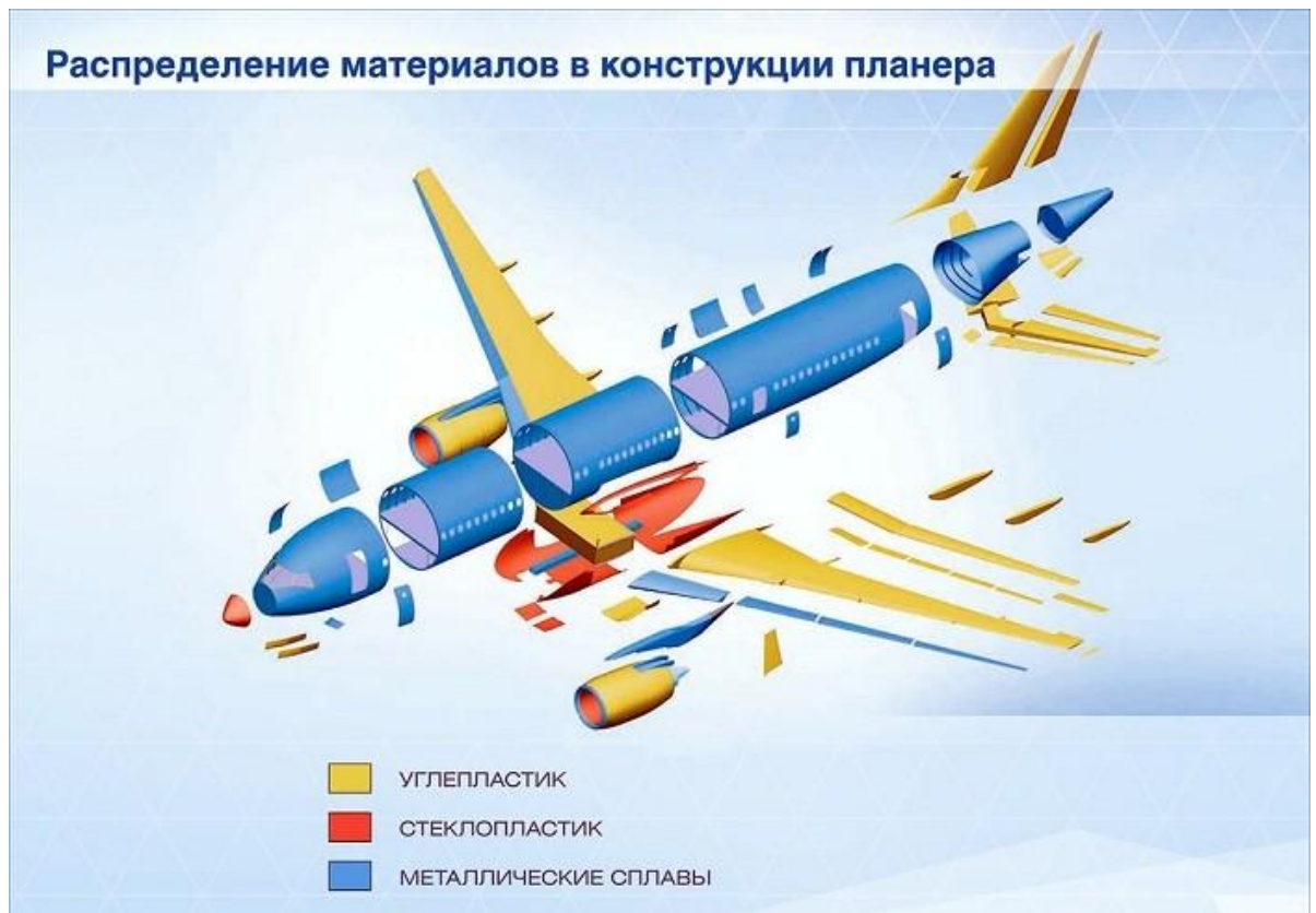
Рисунок 5 - Распределение материалов в конструкции планера МС-21
