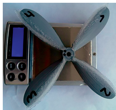
Рис. 1. Нумерация лопастей и внешний вид винта после эксперимента
