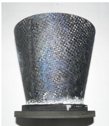
Рис. 6. Насадок №4(с объемным насыщением SiC) после испытаний.
