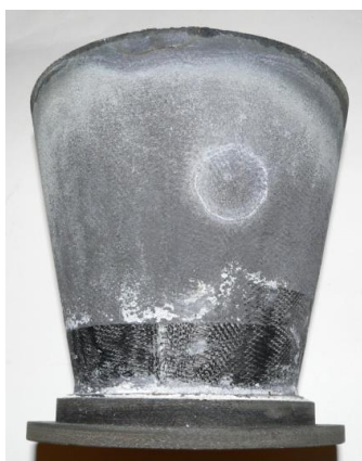
Рис. 8. След окна барокамеры на насадке №1(с покрытием SiC и Al 2 O 3 ) после испытания.
