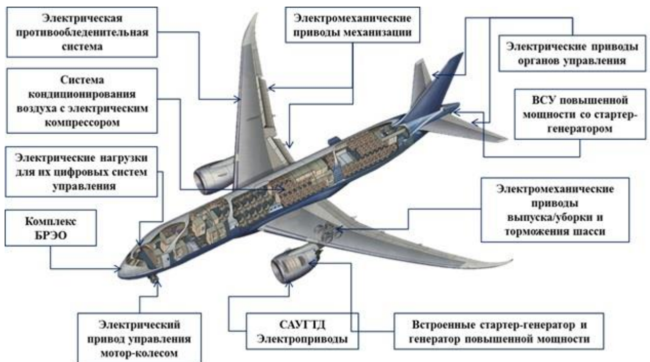
Рисунок 1 – Основные системы полностью электрического самолета
