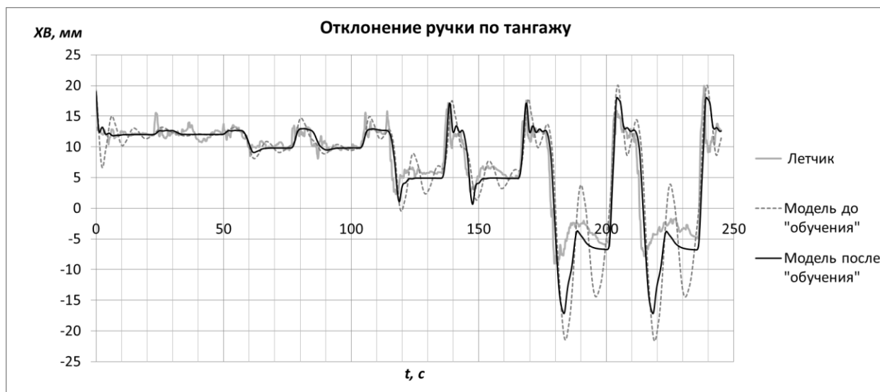
Рисунок 13 – Зависимость перемещения ручки управления самолетом по тангажу, полученная при выполнении задачи пилотирования летчиком и моделью
