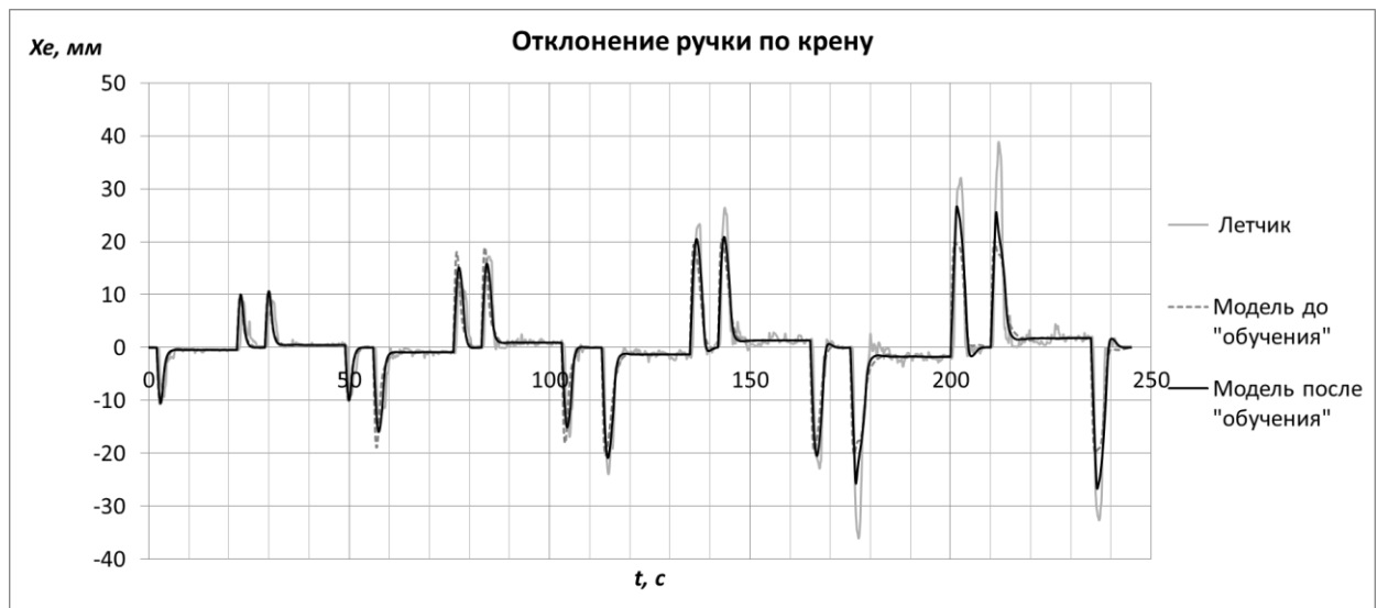
Рисунок 15 – Зависимость перемещения ручки управления самолетом по крену, полученная при выполнении задачи пилотирования летчиком и моделью
