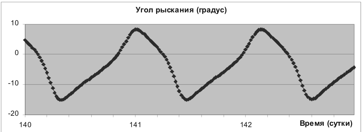
Рис. 9. Изменение угла рыскания на конечном участке траектории
