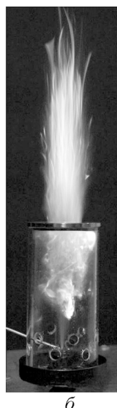
Рис. 1. Схема процесса горения в горелочном устройстве (а) и визуализация процесса горения в горелке со стеклянным корпусом (б)
