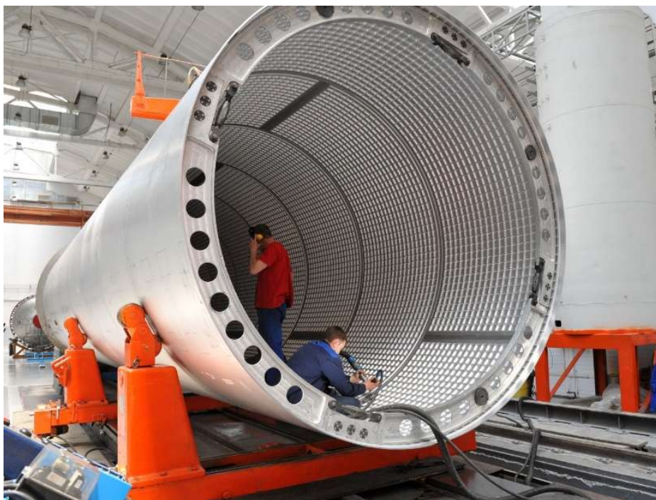
Рисунок 1 – Бак вафельной конструкции РН «Ангара» в процессе изготовления
