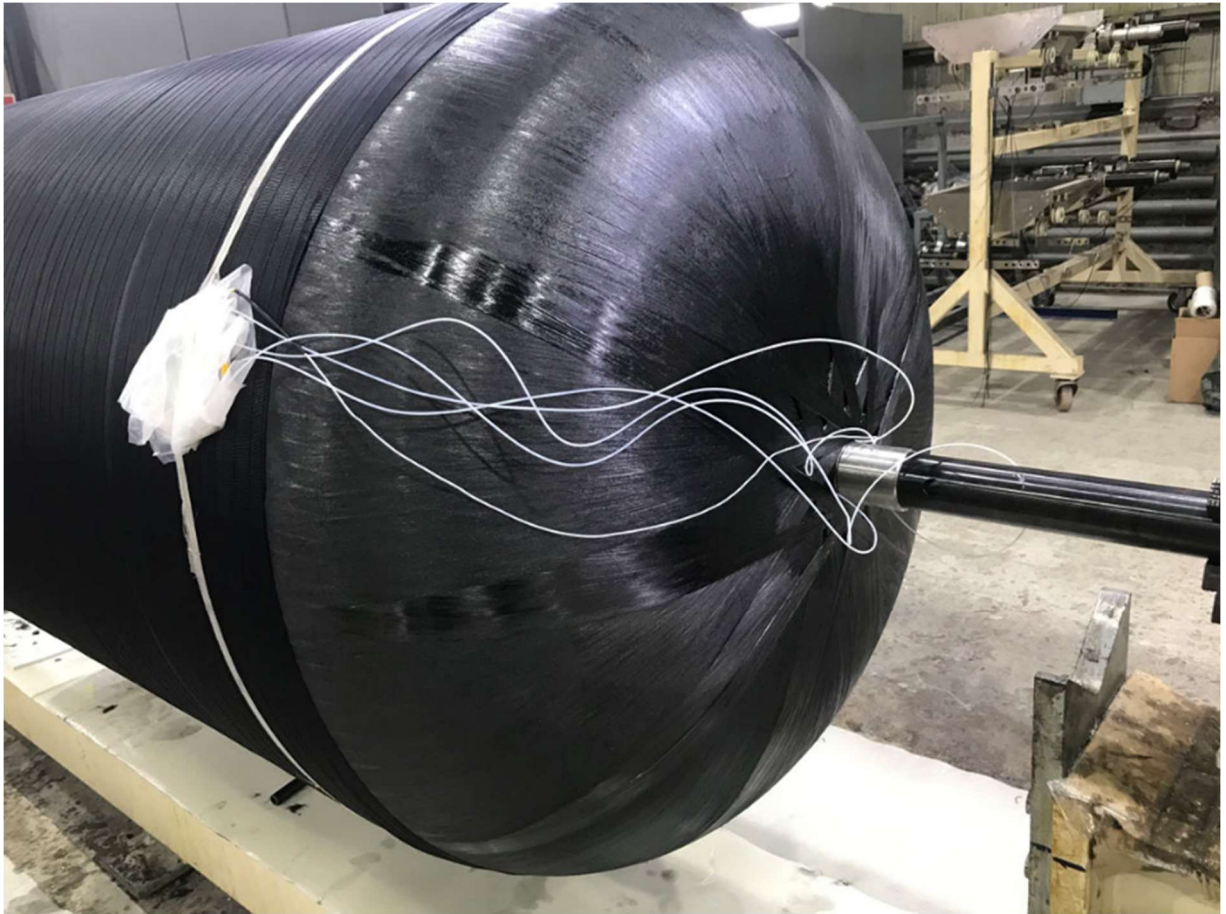
Рисунок 12 – Размещение защищённых выводов оптоволоконной измерительной системы в технологической зоне модельного бака при его изготовлении
