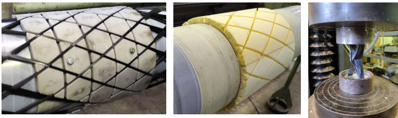
Рисунок 11 – Исследования влияния формообразующего материала на характеристики рёбер сетчатой структуры: использование резиновых подложек (а), пенопласта (б), испытания образцов рёбер (в)
