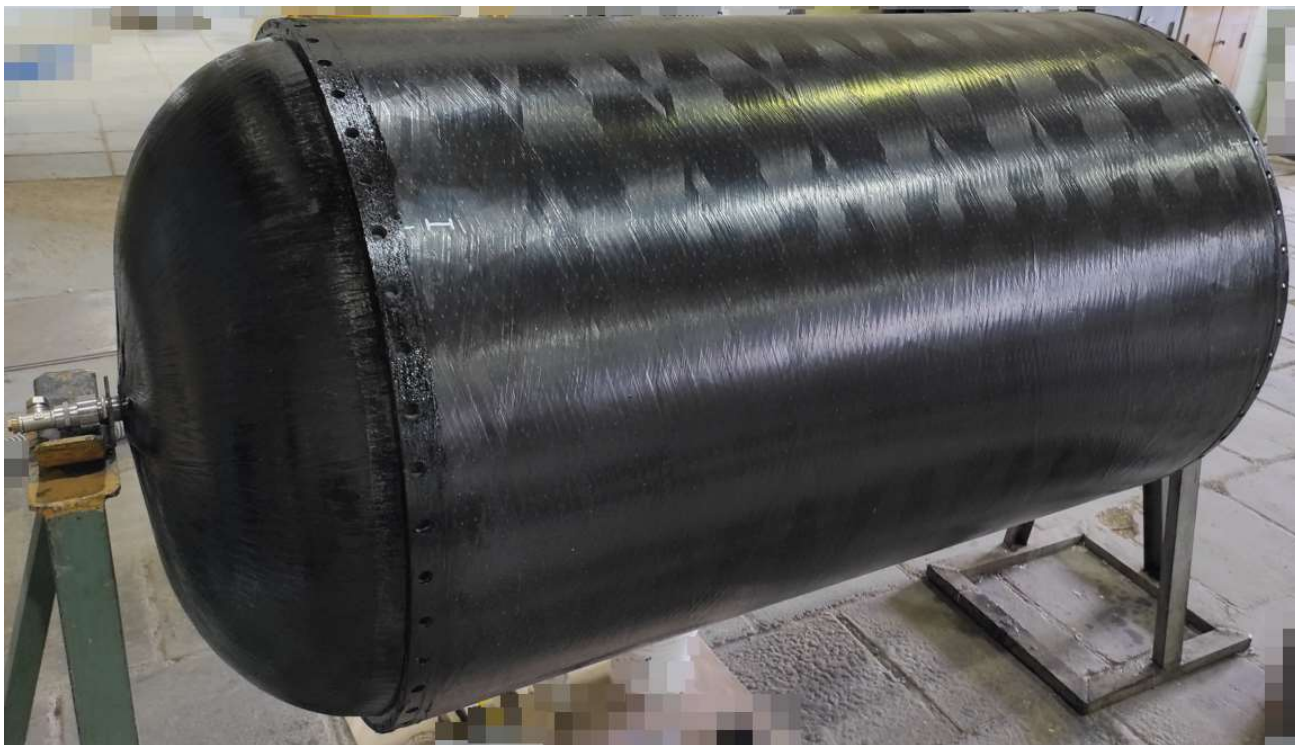
Рисунок 18 – Модельный металлокомпозитный криогенный топливный бак
