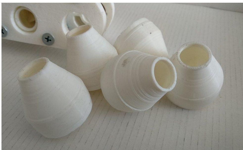
Рис.4 Вид распечатанных форсунок.
