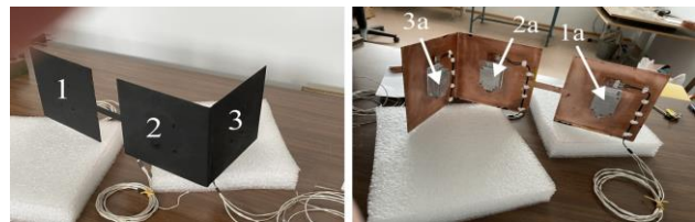
Рис. 4. Общий вид ТТМ: 1, 2, 3 – радиаторы; 1а, 2а, 3а – СНЭ
