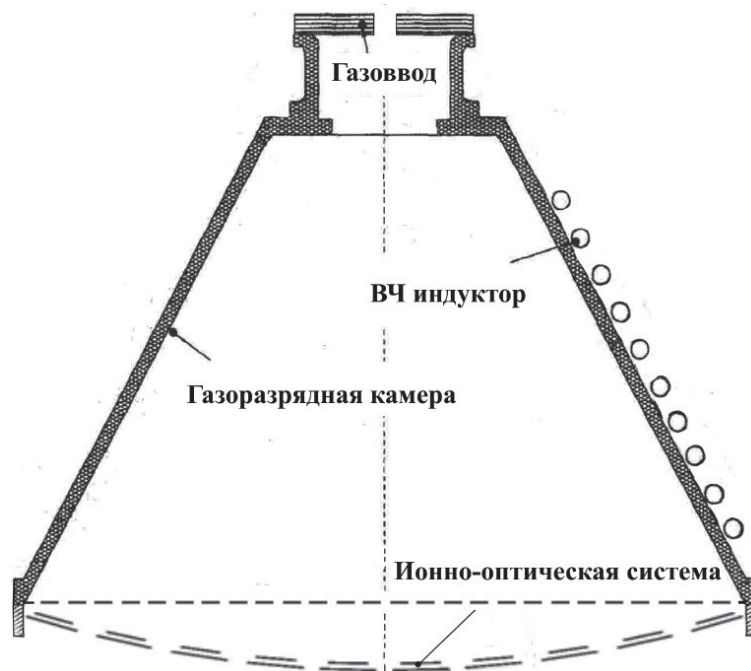
Рис. 3. Схемы высокочастотных ионных двигателей RIT-22 и RIT-XT
