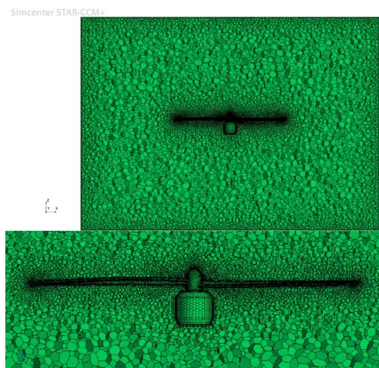
Рисунок 7 – Сеточная модель воздушного винта и корпуса ВМГ, вариант №1, ППП
